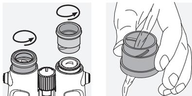
Bij sterke verontreiniging (bijv. zand) kan de oogklep er compleet afgeschroefd worden zodat het oculair eenvoudig kan worden schoongemaakt.
