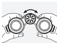
Ruotando la rotella de focalizzazione sarà possibile ottenere un'immagine nitida di qualsiasi oggetto posto ad una distanza ridotta (vedi scheda tecnica) fino all'infinito.
