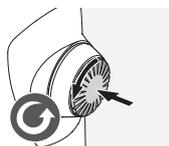
Pressez le bouton vers l'intérieur et tournez-le dans le sens inverse des aiguilles d'une montre (90°).
